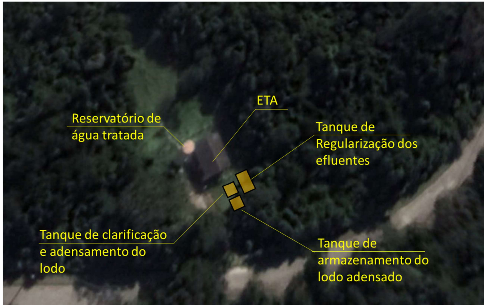
Figura 18 ETA III Layout preliminar de implantação do sistema de tratamento dos efluentes
