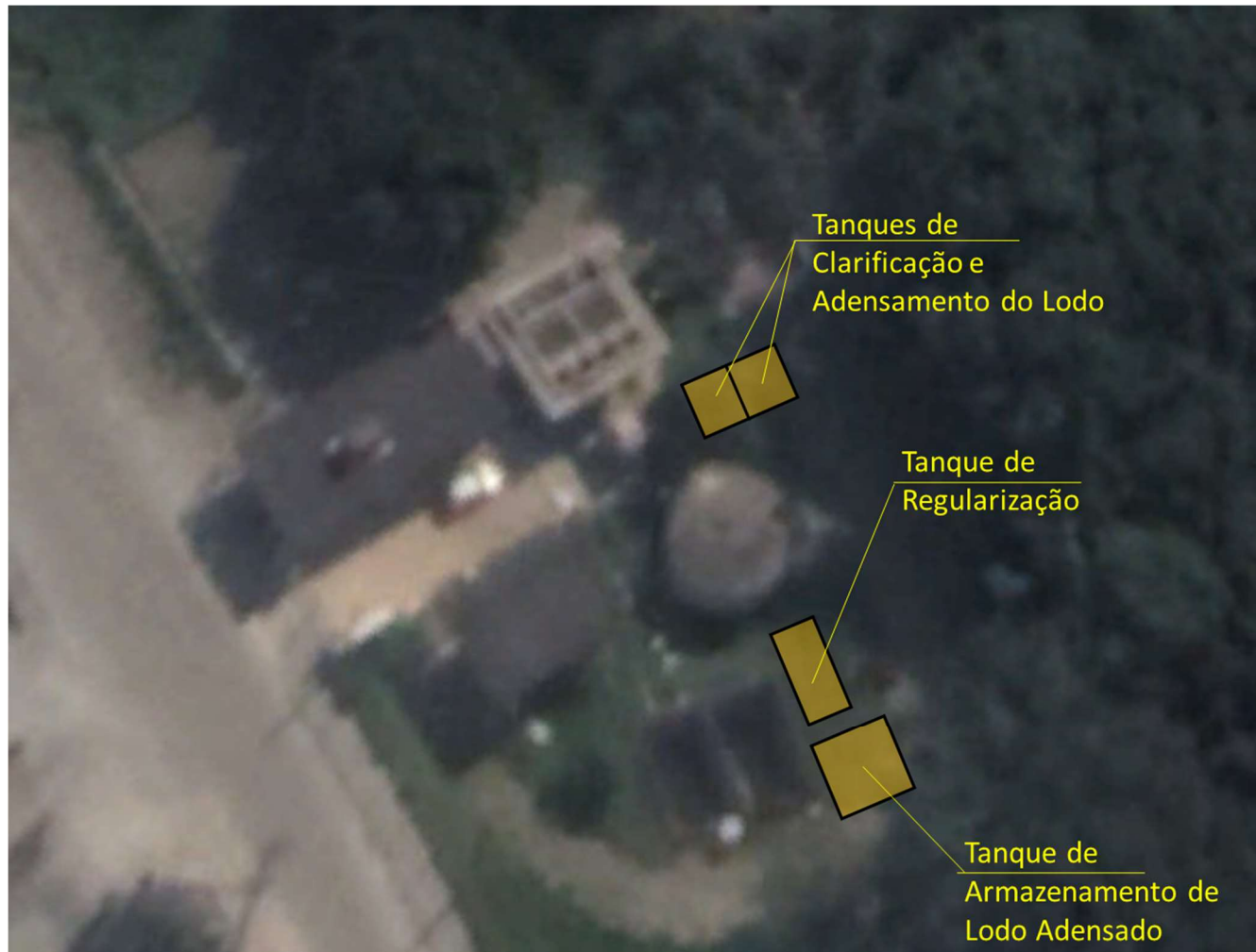
Figura 14 Layout preliminar proposto para a implantação do sistema de tratamento dos efluentes
